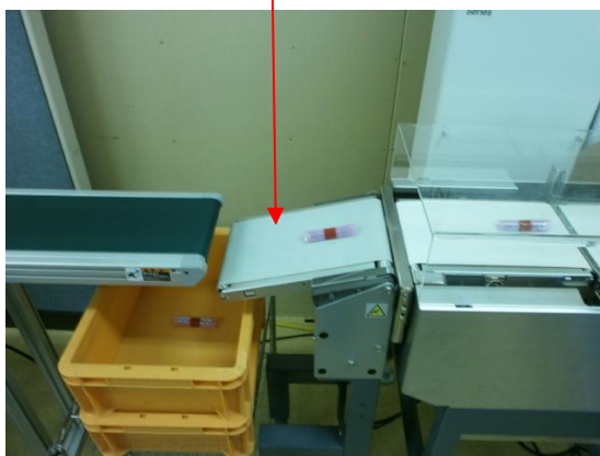
選別板(ドロップアウト方式=不良品を下に落とす)
